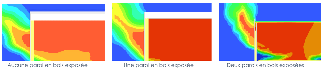
Figure 5 : Panache de flammes extérieur en fonction du nombre de parois en bois exposées au feu
