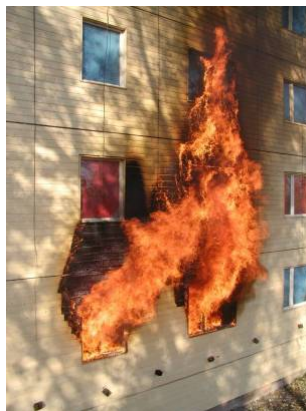
11 ème minute La façade s'enflamme (ventilateur à l'intérieur pour simulation)
