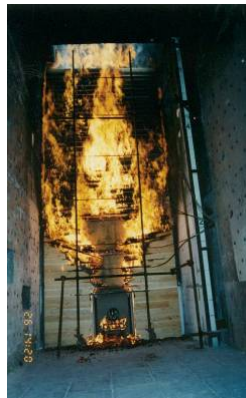
Bardage à clin ventilé, sans mesures de protection
