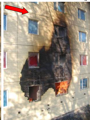
32 ème minute La façade en bois ne brûle plus par elle-même
