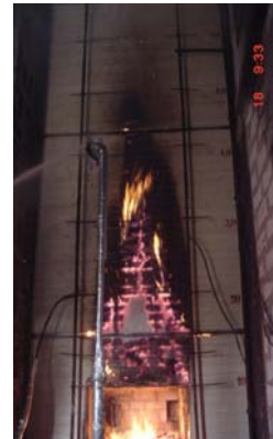
Bardage R+C ventilé, avec mesures de protection
