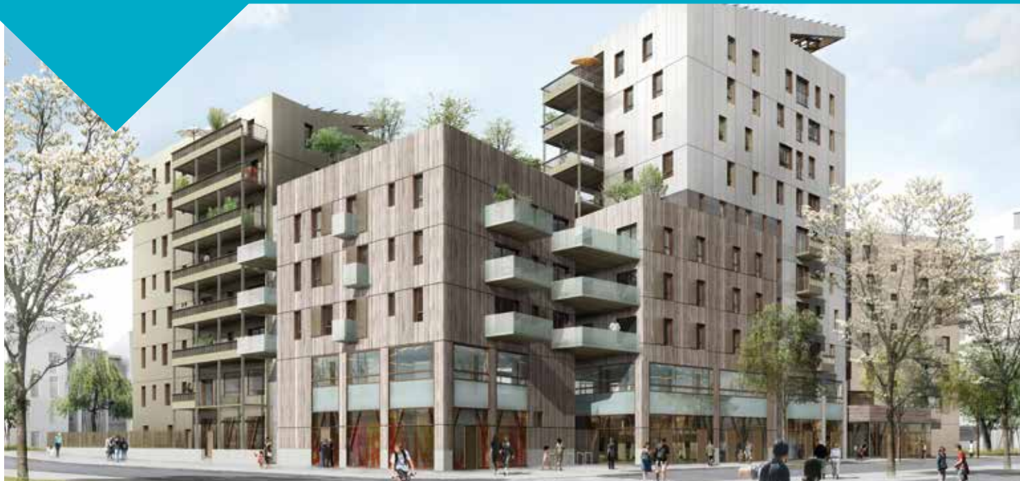
L'ILOT BOIS, STRASBOURG : La communauté urbaine de Strasbourg réalise un quartier où tous les immeubles seront en bois. Ici, l'un des 3 projets en cours, avec super-structure bois en R+9 : Architectes : Atelier Philippe Madec / Atelier D / Méandre ; BET : Gaujard ; maîtrise d'ouvrage : Nacarat
